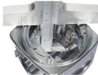
Modelli di profondità con piedino di misura girevole
